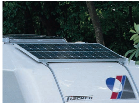
Solaranlage, bestehend aus einem 75-W-Modul, Ladestromregler. Gewicht: 14.5 kg
