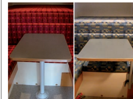
Aluminium-Schwenktisch (Bild rechts) anstelle Einsäulentischfuss (Bild links). Mehrgewicht: 2 kg
