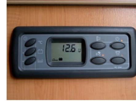
Digitales Bord-Control-System mit Aussen- und Innentemperatur-Anzeige, Zeituhr und optionalem Aussenlicht-Schalter.
