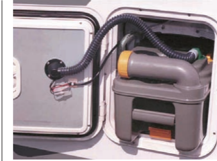
SOG-Toilettenentlüftung. Gewicht: 0.5 kg
