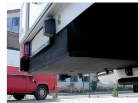
Abwassertank, isoliert und beheizt. Gewicht: 5 kg
