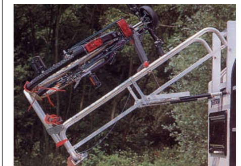
Fahrradträger klappbar oder festmontiert für 2 Fahrräder. Gewicht: 14.5 kg (klappbar), 6.2 kg (festmontiert)
