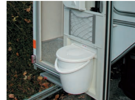
Einstiegstüre mit integriertem Fliegengitter und Mülleimer: Mehrgewicht: 4.5 kg
