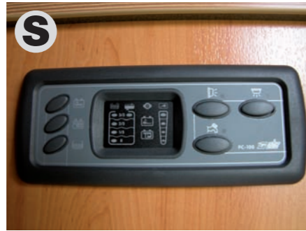
Bord-Control-System für Frisch- / Abwassertank, Aufbau- / Fahrzeugbatterie, 12-V-Hauptschalter und Wasserpumpenschalter.
