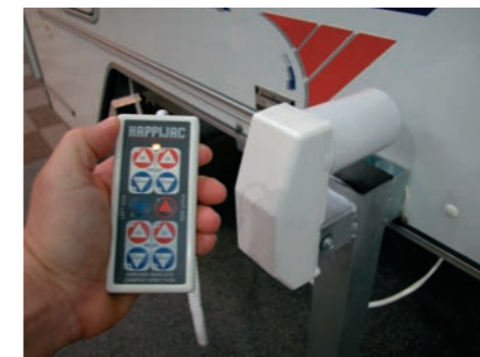
Elektrostützen. Mehrgewicht: 13 kg
